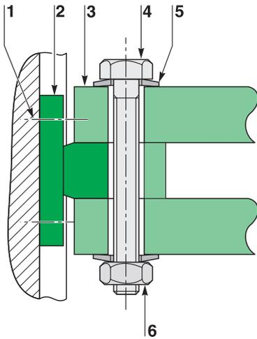
1. Винт крепления с заводской затяжкой (16 Нм)
