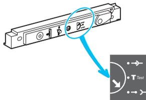
Вставьте дужку навесного замка(ов) (максимальный диаметр 5-8 мм).
