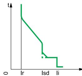
С длительной задержкой срабатывания + С кратковременной задержкой срабатывания + Мгновенная токовая отсечка
