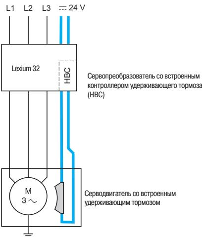
Встроенный в серводвигатель BMH удерживающий тормоз представляет собой электромагнитный тормоз с нажимными пружинами, блокирующий вал серводвигателя после отключения тока питания серводвигателя.
