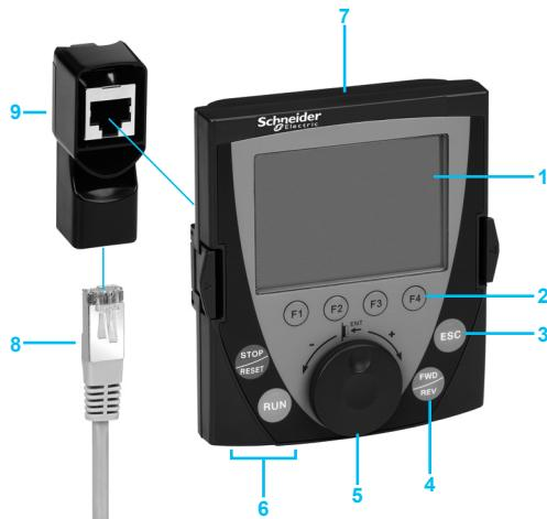
Выносной графический терминал
